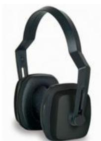
O abafador de ruídos Comfo 500, é composto por duas conchas de PEAD de alta densidade, duas espumas internas de PU - Poliuretano, arco em POM - Poliacetal, e atenuação de 15dB NRRsf. Confortável, apresenta excelente vedação e máxima proteção ao usuário. O prático encaixe e design da concha no arco proporciona giro de 360° da concha, possibilitando a utilização mesmo quando utilizado capacete de segurança. O EPI possui kit higiênico para reposição composto por dois selos e duas espumas internas.
